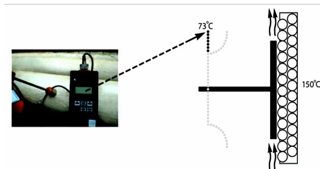
Высокая отражательная способность и низкая степень черноты (замкнутые разряженные полости, обладают пониженной степенью черноты) покрытия Корунд **приводят к существенным ошибкам при использовании пирометров и тепловизоров**, градуировка которых осуществляется с использованием модельных чернотельных излучателей, предназначенных для значений излучательной способности, близкой к  $\epsilon \approx 0,99$ , работающих в спектральном диапазоне волн 7-18 мкм.
