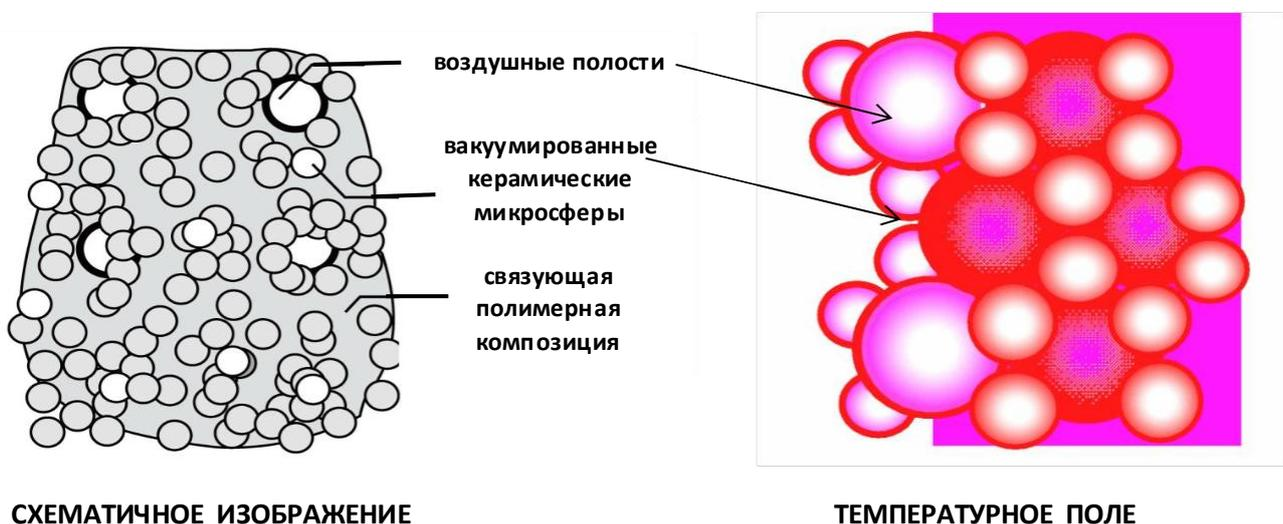
Рис. 1 Схематичное и тепловое изображение сверхтонкого керамического покрытия.
